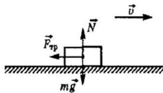
2)  $F_{\text{упр}} = F_{\text{тр}}$  (при равномерном движении);
